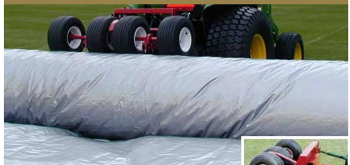
Con TARP MACHINE™, se puede mover cualquier rodillo para protectores de césped. Es una herramienta indispensable para los que usan lonas con frecuencia o para cuando el personal no está disponible. El chasis bien construido está hecho con acero tubular de gran calibre y marcha sobre dos neumáticos estándar grandes para césped. La transmisión directa de la toma de fuerza hace rotar las cuatro ruedas motrices neumáticas, las cuales a su vez mueven la lona y su rodillo sobre el césped.
