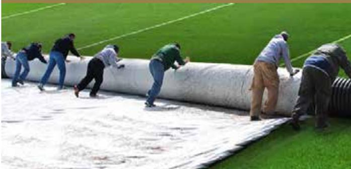
Diseñado para instalar, remover y guardar cualquier protector para campo de COVERMASTER®, TARPMATE™ es un rodillo fuerte y liviano, muy fácil de manipular. Hecho con plástico, no se oxidará ni corroerá. Un núcleo interno brinda una mayor resistencia general, mientras que sus corrugaciones anulares permiten que se enrolle en línea recta. TARPMATE™ también está disponible con protecciones de SEGURIDAD opcionales para los extremos, que además evitan que los roedores y otras plagas aniden adentro.
